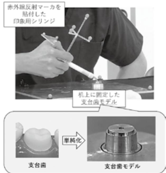
図1 実験の様子と製作した支台歯モデル
